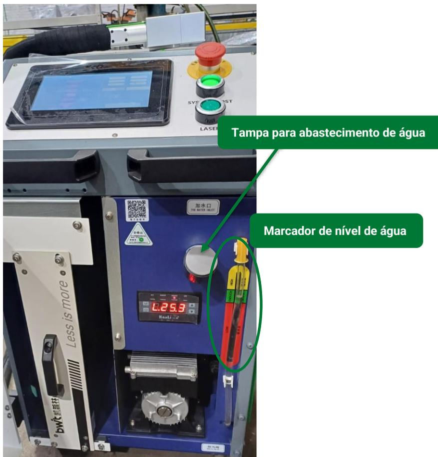
**ATENÇÃO:** A água utilizada no sistema possui vida útil de até 3 meses. Após este período, é obrigatória a substituição para garantir o desempenho e a integridade do equipamento.
