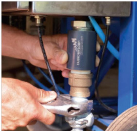
3. Usando uma chave, solte o acoplamento do cano de ar da válvula esférica (veja gravura ao lado).
