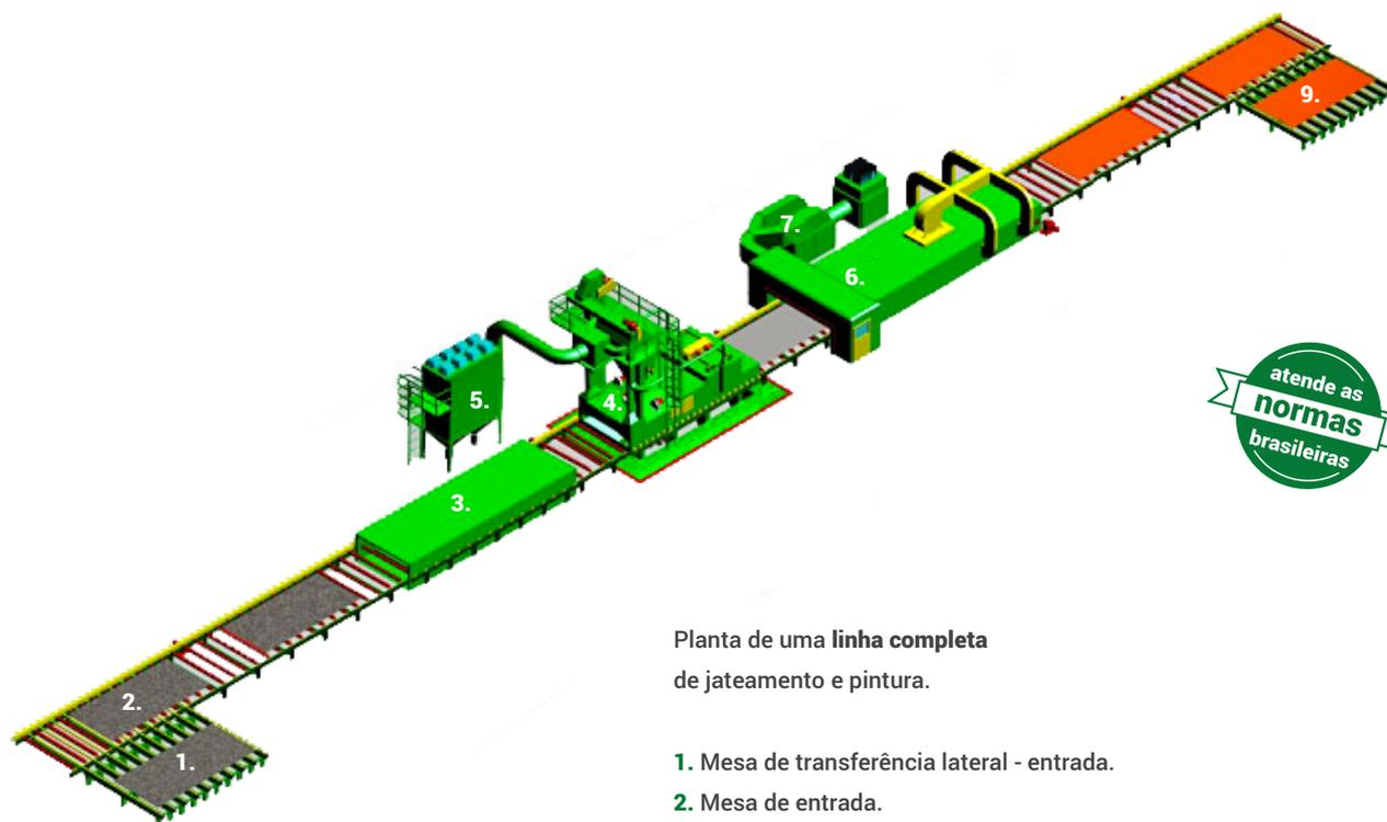
Planta de uma **linha completa** de jateamento e pintura.
